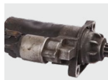
Znatno deformirano kućište
