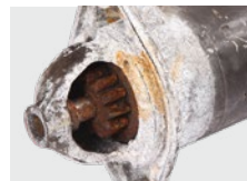
Korodirao je pogonski zupčanik i remenica
