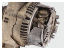
Oštećen zaštitni poklopac
