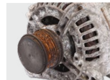
Korodirao je pogonski zupčanik i remenica
