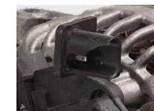
Oštećena utična spojnica ispod brtvenog prstena
