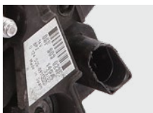
Oštećenje na utičnoj spojnici, sve do brtvenog ruba
